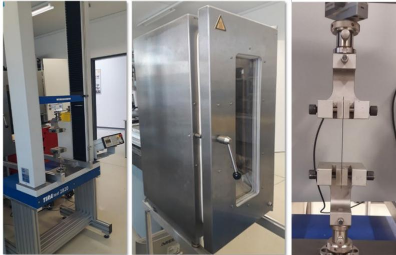
Abbildung 2: Zug-Druck-Prüfmaschine (links), zuschaltbare Wärmekammer (mitte), Einspannsituation (rechts)
