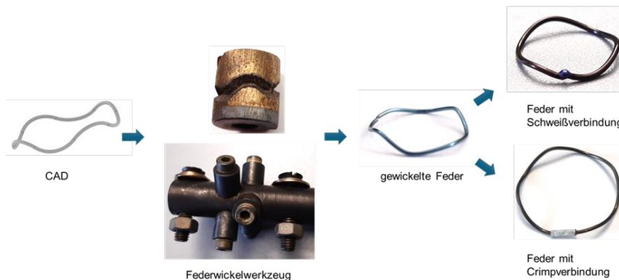
Abbildung 13: Fertigung Wellenfedern
