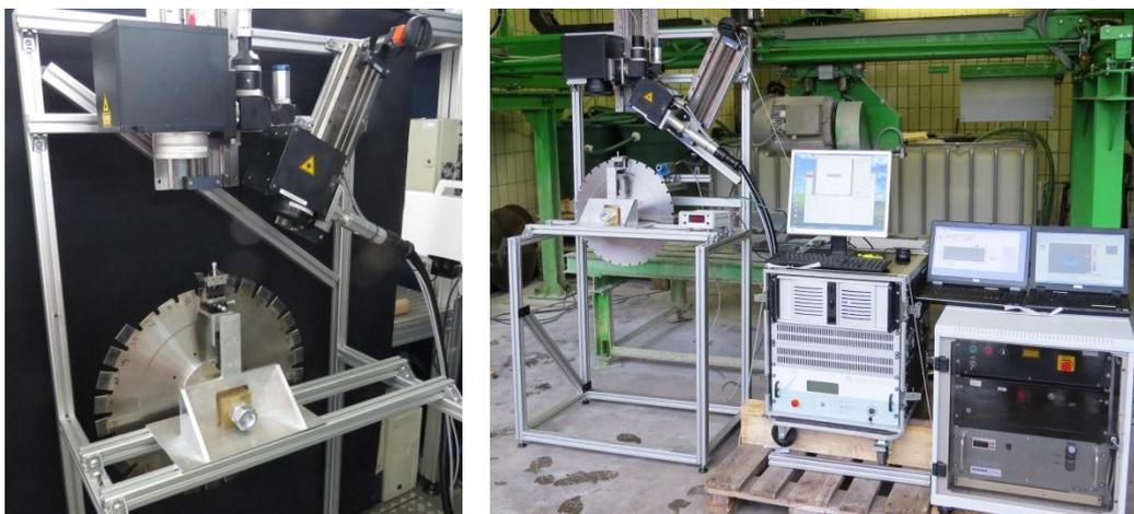
Abbildung 8: Demonstrationseinheit im Einsatz bei der lasergestützten (Wieder-)Bestückung von Sägeblättern im Labor (links) und beim mobilen Einsatz vor Ort (rechts).
