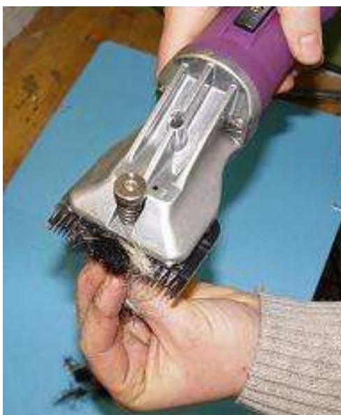
Prüfung der Schneidfähigkeit von TiAlN-beschichtete Pferdescherkämme
