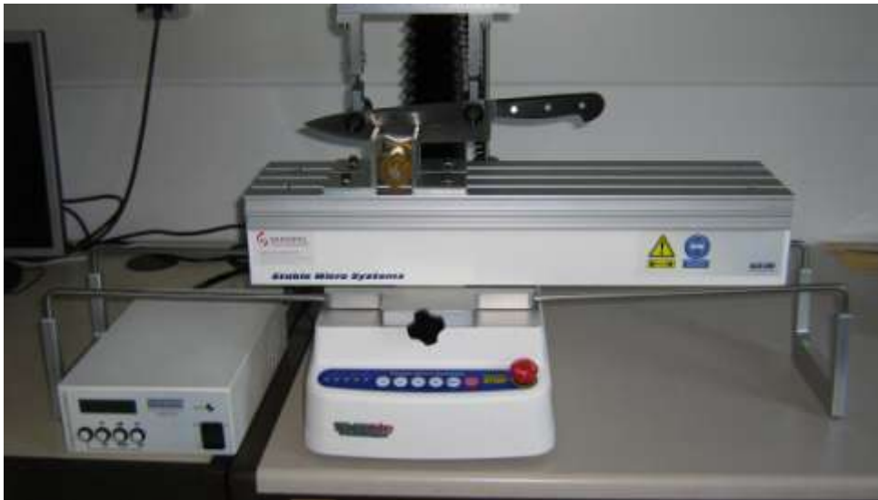
Abbildung 1: Neuer Prüfstand zur Schneidfähigkeitsprüfung
