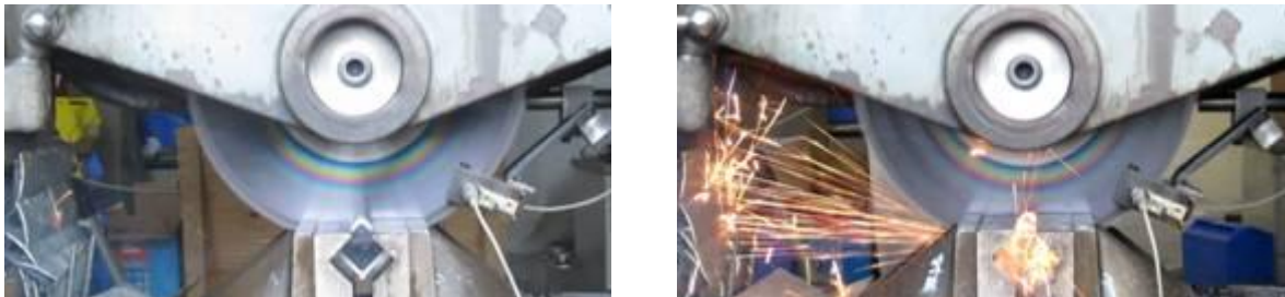
Abbildung 1: Zunahme der Spänetemperaturen mit steigendem Werkzeugverschleiß
