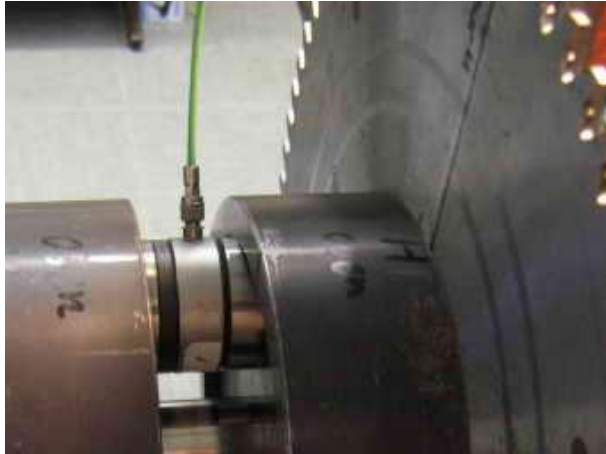
Abbildung 3: Spannkraftermittlung in Abhängigkeit vom Spanndrehmoment an Flanschsystemen
